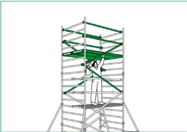
Gerüst wie oben weiterbauen bis die erforderliche Höhe erreicht ist. Gerüstmontage für Gerüste über 4.20 m sollten durch mind. zwei Personen aufgebaut werden.
