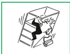
Das Gerüst immer auf der **Innen-seite** besteigen. Falls keine Treppen vorhanden sind, klettert man auf der Innenseite an den Seitensprossen via Durchstiegsplattformen hoch. Das Rollgerüst kann beim Hochklettern an der Aussenseite kippen.
