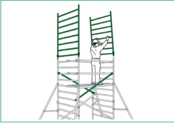
Diagonalstreben werden in entgegengesetzter Richtung zwischen der 6. und 10 Sprosse montiert. Anschliessend nächste Aufbaurahmen anbringen und mit Sicherungsstiften fixieren.
