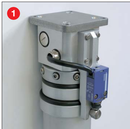
Tête du mât avec presse-étoupe 1 x PG9, 1 x PG11, 1 x PG13,5 et support de fixation de 8 mm, montée sur les sections rainurées clavetées
