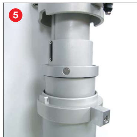
5 Capuchon à la tête du mât pour protéger les sections rainurées clavetées
