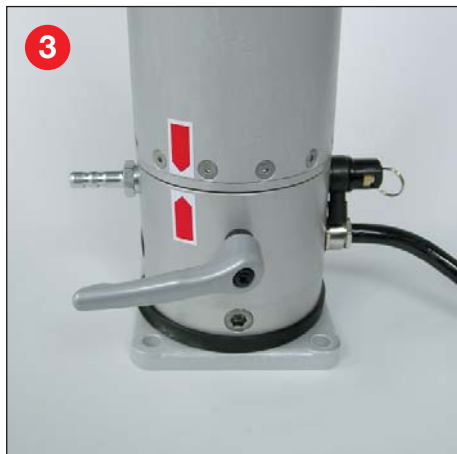
3 Base rotative sur 360° avec cardan, connexion d'air, soupape de vidange/sûreté et système de serrage
