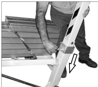
Biegen Sie den Fuß bis er mit dem Sockel einen Winkel von 90 Grad bildet.
