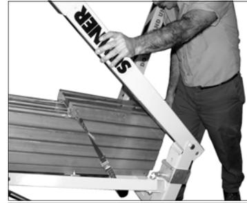
Indem Sie den Fuß in einen Winkel von 90 Grad halten, schieben Sie die Verriegelung des Fußes zurück zum Fuß, bis der gefederte auchstift in Position springt.
