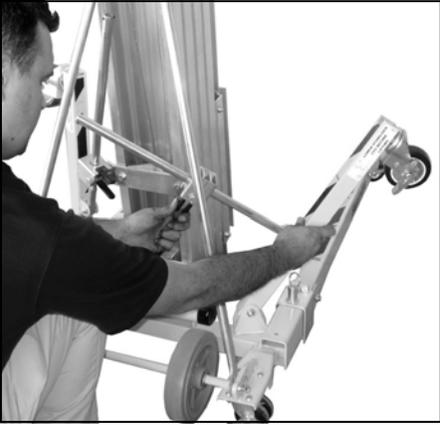
Um das Bein in der verstauten Position zu ersetzen, kneifen die Verriegelung Freisetzung und falten Sie das Bein.
