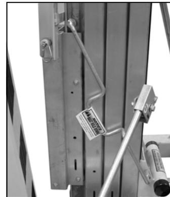
Zum Lösen Hold Down, Zugstange zu Ihnen und stellen sich hinter Mastabschnitten.
