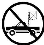
Wenn das Gerät eine angehobene Last trägt, darf es nur mit den 12,5 cm Transportrollen transportiert werden. Betätigen Sie das Gerät nicht auf einer unbeständigen Plattform, wie z.B. auf der Pritsche eines LKWs.
