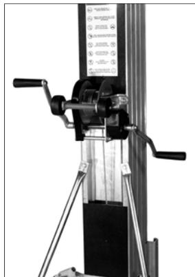
Mit der Winde kurbeln Sie die Gabeln aufwärts bzw. abwärts in die gewünschte Position. Dann kurbeln Sie die Windengriffe um ca. 1/4 Drehung aufwärts, um die Sicherheitsbremse einzustellen.
