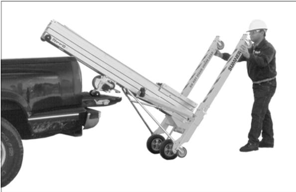
**WICHTIG** Bevor Sie das Gerät in die Liegeposition kippen, muss der Träger in Abwärts-Position unterhalb der roten Pfeile stehen, und Sie müssen sicherstellen, dass der Sicherheitsriegel eingerastet ist.
